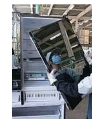
冷蔵庫のガラスドア取り外し
