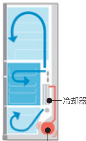
コンプレッサー運転
